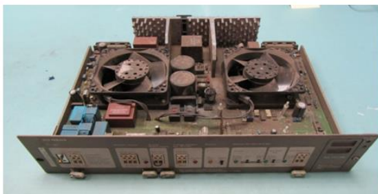
Bild 1: Ein Netzteil, wie es aus dem Betriebsalltag in die Wartung kommt. Durch Verschmutzungen kommt es häufig zu Störungen der Spannungsversorgung.
