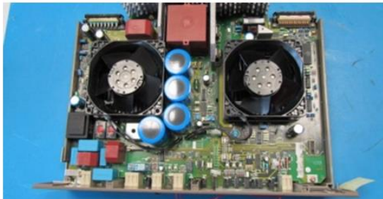
Bild 2: Ein Netzteil nach der Wartung und vorbeugender Überholung aller mechanischen und elektronischen Systeme - fit für den Dauerbetrieb.
