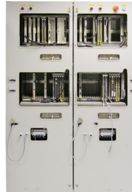
Die neueste Prüfstandgeneration unterstützt die vollautomatisierte Parameterprüfung mit aussagefähigem Prüfprotokoll und Garantieverlängerung auf 18 Monate. Im Bild modularer Prüfstand für S5-Baugruppen der Serien 115/135/155.
