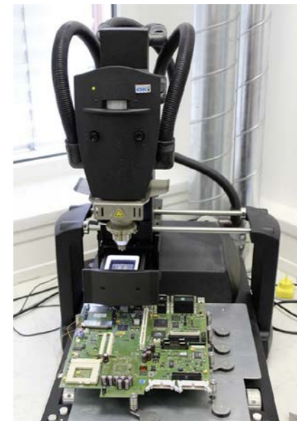
Ein Lötroboter, mit dessen Hilfe BGA-Chips aus- und eingelötet werden können.
