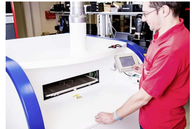
Hochleistungs-Dampfphasenlötanlage Mit einem patentierten Verfahren können bei EICHLER u.a. sporadisch auftretende Fehler sicher und schnell beseitigt werden.
