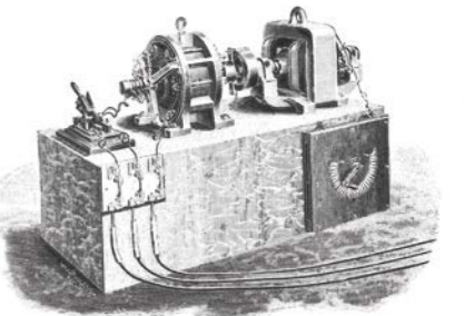
Zwei PS-Drehstrommotor der AEG vom Jahre 1890 mit angekuppelter Gleichstrom-Belastungsmaschine.
