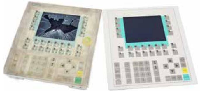
Trotz Produktabkündigung wird aus einem verschmutzten und defekten Bauteil bei der EICHLER GmbH wieder ein zuverlässiger Helfer im Produktionsablauf.
