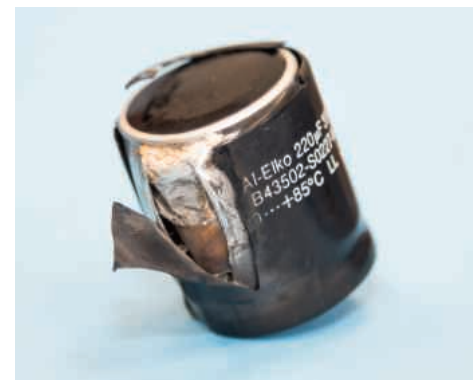
Werden Umrichter nach längerer Lagerdauer in der Anlage verbaut, kann es zu gefährlichen Explosionen kommen. Regelmäßig durchgeführte Formierungen beugen dem Risiko vor.
